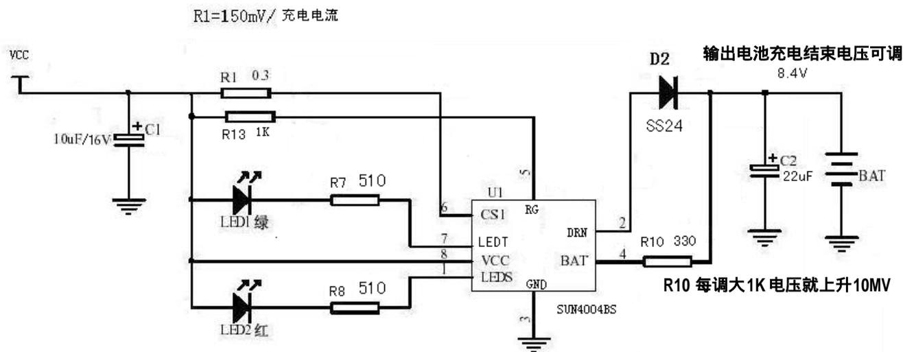
$$V_{OUT} = (R10 * 10mV) + 8.4V \quad R10 \text{ 以“K”为单位}$$
