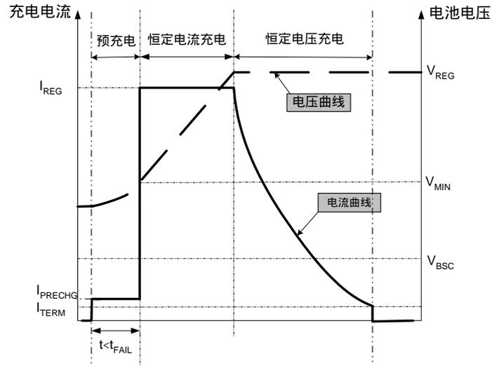
图 4 充电过程中的电流、电压曲线
