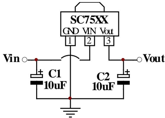
2、高输出电流稳压电路
