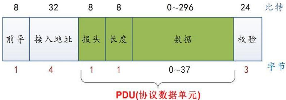
HS0861支持BLE4.0的广播包发射，PDU协议单元数据用户自定义填充，实现ibeacon以及用户自定义beacon的发射，接收时可接收所有BLE广播格式的数据包。
